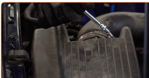
**5** Koble røret til luftinntaket fra luftfilterhuset.
