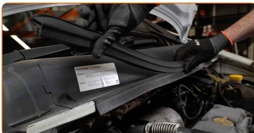
**4** Fjern øvre del av av torpedoplaten.
