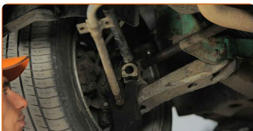
**7** Rengjør montasjeflaten til stabilisatorstag foringene. Bruk en stålbørste. Bruk WD-40 spray.
