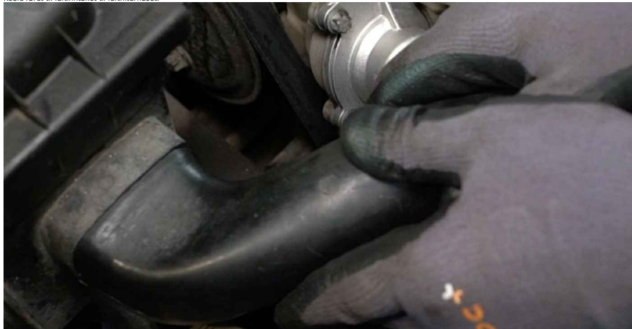
32 Fest klipsset på inntaksslengen til luftfilteret.
