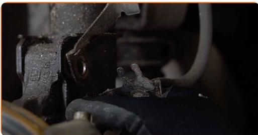
**17** Koble styrespindelen fra fjærbeinet. Bruk et brekkjern.
