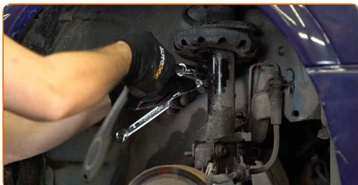
**13** Skru løs nedre feste som kobler fjærbein til styrespindel. Bruk en kombinasjonsnøkkel #18. Bruk en pipenøkkelinnsats #18. Bruk et svingjern.
