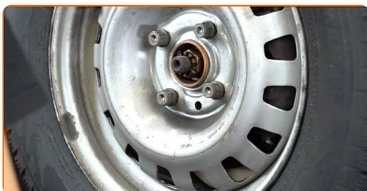
**41** Senk bilen og stram hjulboltene, arbeid på kryss. Bruk en momentnøkkel. Stram den til 110 Nm dreiemoment.
