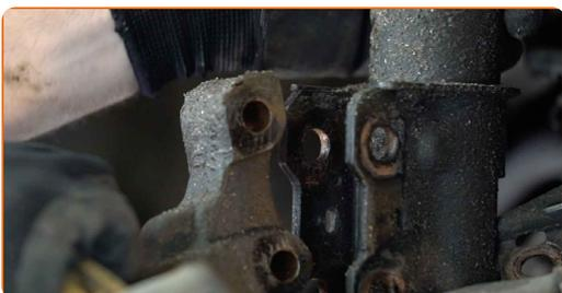
**18** Skru løs det øvre festet på fjærbeinet. Bruk en kombinasjonsnøkkel #17. Bruk en pipenøkkelinnsats #9.
