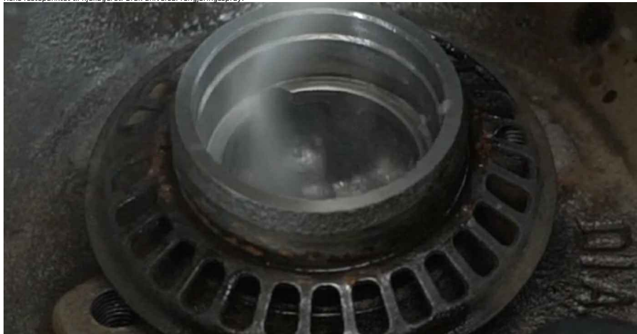
18 Monter en ny ytre ring til hjullageret i bremsetrommelen. Avtrekkersett for hylser og lager.
