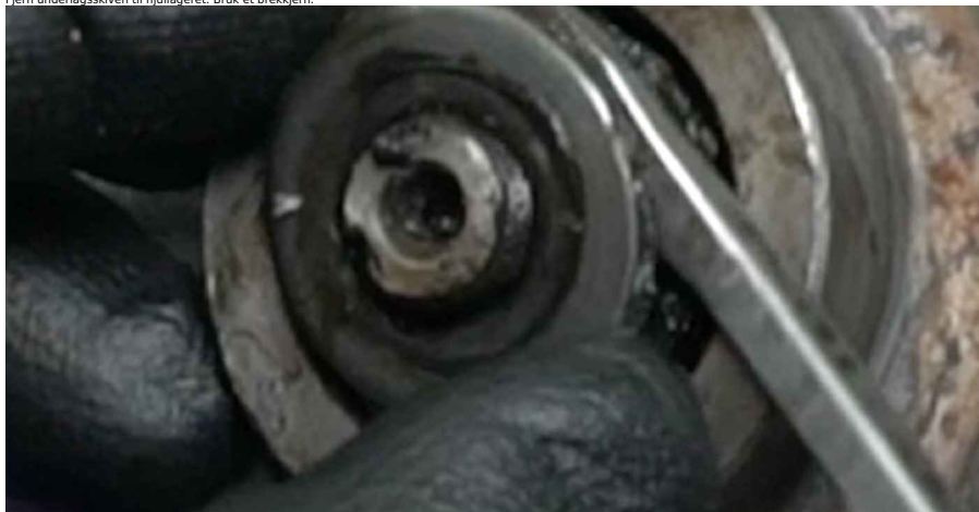
10 Fjern hjulnavlageret. Bruk et brekkjern.
