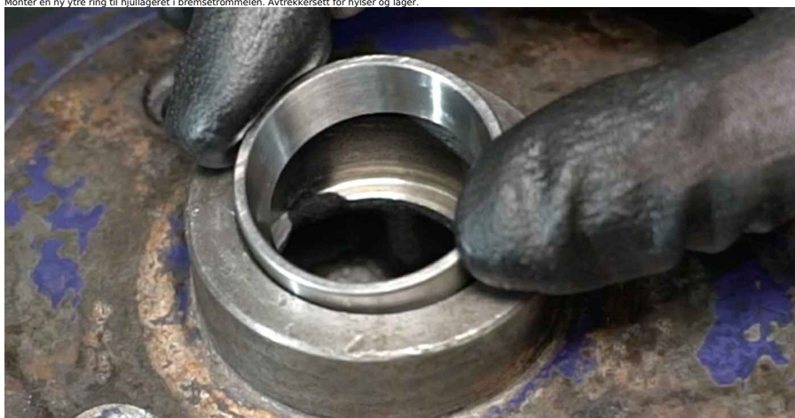
19 Monter den nye indre kulebanen til hjullageret til bremsetrommelen. Avtrekkersett for hylser og lager.
