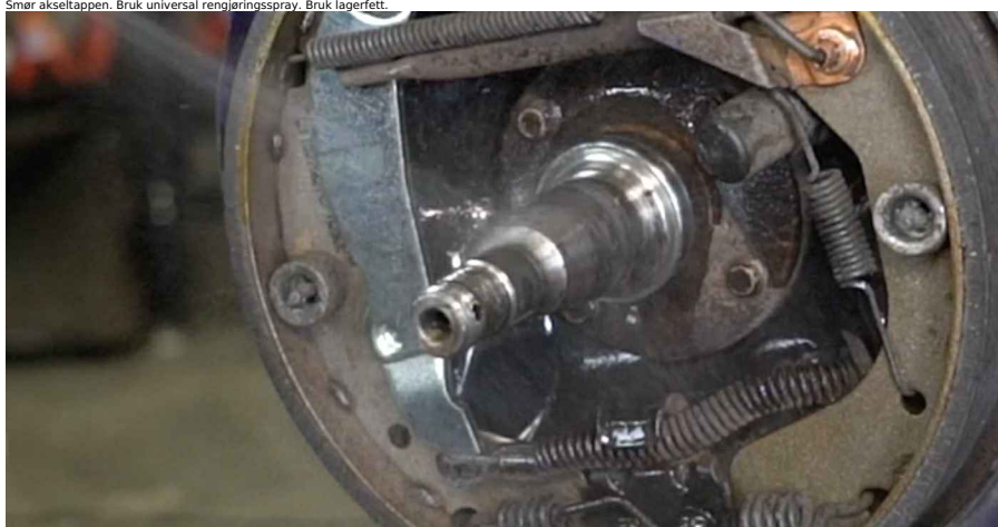
24 Monter bremsetrommelen i en montasje med hjulnavlageret.
