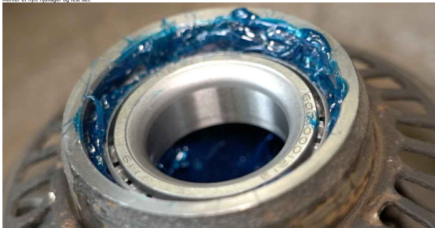
22 Monter oljepakningen til hjullageret.
