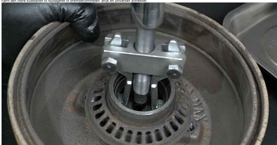
15 Fjern den indre kulebanen til hjullageret til bremsetrommelen. Bruk en universell avtrekker.
