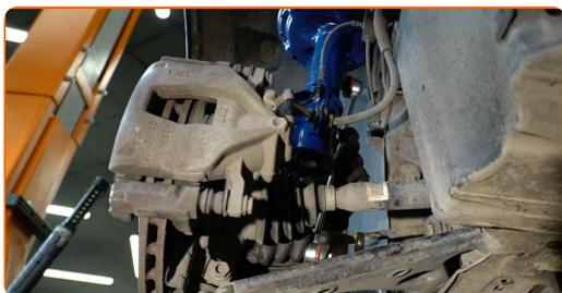
**12** Stram festene som kobler stabilisator-ledd til stabilisatorstag. Bruk en kombinasjonsnøkkel #17. Bruk en pipenøkkelinnsats #17. Bruk en momentnøkkel. Stram den til 40 Nm dreiemoment.
