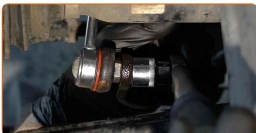
**13** Stram festene som kobler stabilisator-ledd til fjærbein. Bruk en kombinasjonsnøkkel #17. Bruk en pipenøkkelinnsats #17. Bruk en momentnøkkel. Stram den til 40 Nm dreiemoment.
