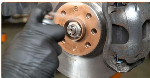
**16** Rengjør overflaten av bremseskiven. Bruk bremsrens.
