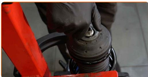
43 Stram fjærbeinets stempelstangmutter. Bruk en pipenøkkelinnsats #18. Bruk Torx T40. Bruk en momentnøkkel. Stram den til 50 Nm dreiemoment.
