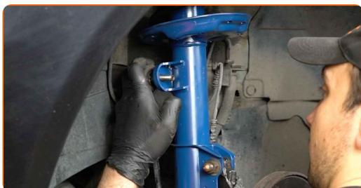
**58** Stram festene som kobler stabilisator-ledd til fjærbein. Bruk en kombinasjonsnøkkel #15. Bruk Torx T30. Bruk en momentnøkkel. Stram den til 40 Nm dreiemoment.
