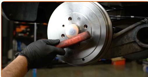
**40** Behandle overflaten hvor hjulfelgen kommer i kontakt med bremsetrommelen med et egnert middel. Bruk kobberfett.
