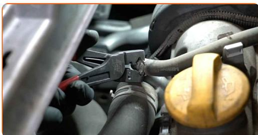
**22** Fjern kjølevæskeslangen. Bruk en flat skrutrekker.
