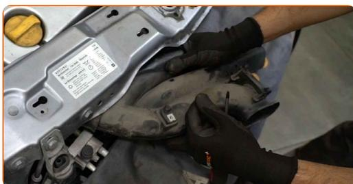
**5** Skru løs festet på motordekselet. Bruk Torx T30. Bruk en skrallenøkkel.
