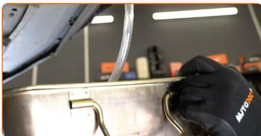
**16** Åpne tappehanen for kjølevæske. Bruk en flat skrutrekker.
