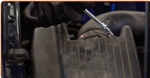
**4** Koble røret til luftinntaket fra luftfilterhuset.
