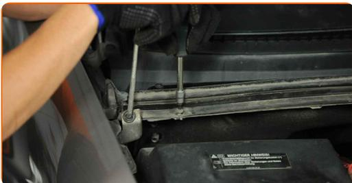
**20** Fjern klemmene fra plastgrillen på panseret. Bruk en flat skrutrekker. Bruk en øreklemmetang.
