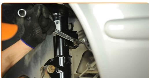
**74** Koble ABS-sensorkabelens lås til fjærbeinet. Koble til festet til slitasjesensorledningen for bremseklosser til fjærbeinet.
