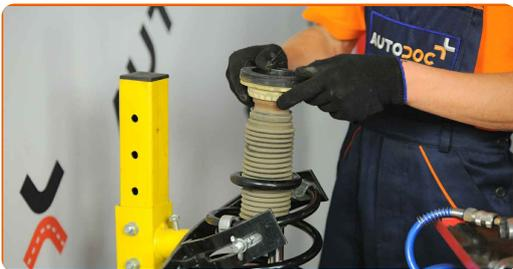
**45** Stram fjærbeinets stempelstangmutter. Bruk en pipenøkkelinnsats #20. Bruk en momentnøkkel. Stram den til 56 Nm dreiemoment.
