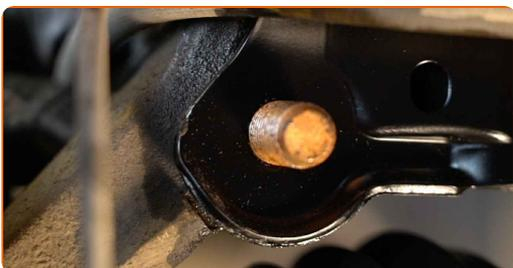
**70** Stram nedre fester som kobler fjærbein til styrespindel. Bruk en kombinasjonsnøkkel #21. Bruk en pipenøkkelinnsats #21. Bruk en momentnøkkel. Stram den til 120 Nm dreiemoment.+75°
