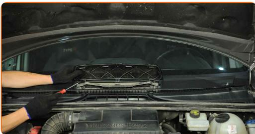
**25** Ta ut kupøfilterbraketten. Bruk Torx T25. Bruk en skrallenøkkel.
