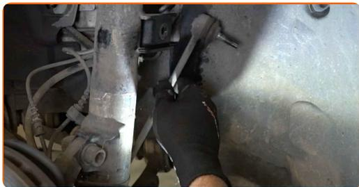
**9** Fjern bremseslangen fra fjærbeinet. Bruk en flat skrutrekker.
