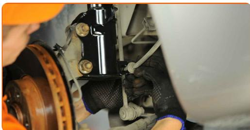
**72** Sikre stabilisatorkoblingen på suspensjonsavstiveren. Bruk et brekkjern.
