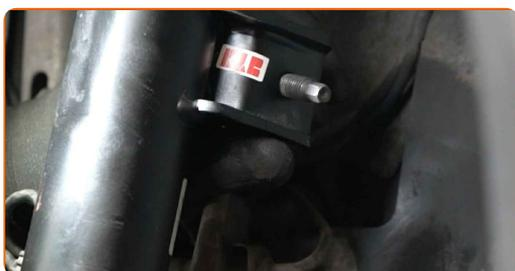
**73** Stram festene som kobler stabilisator-ledd til fjærbein. Bruk en pipenøkkelinnsats #18. Bruk en momentnøkkel. Stram den til 85 Nm dreiemoment.
