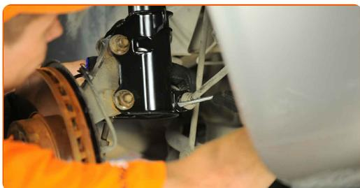
**10** Løs ledningsnett til ABS-sensoren fra holderen på støtdempere. Koble fra festet til slitasjesensorledningen for bremseklosser fra fjærbeinet.
