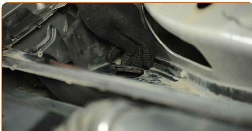
**53** Sett inn kontakten til vindusviskermotoren.
