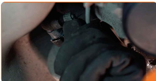
**8** Trykk på trykk kontrollventilen. Bruk en flat skrutrekker.
