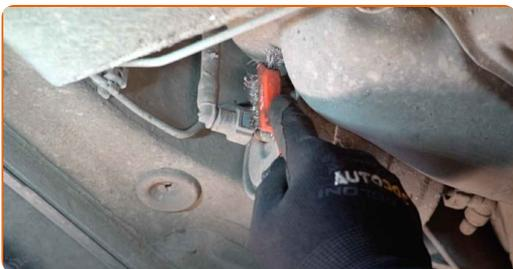
**6** Rengjør braketten til drivstoffilteret. Bruk en stålbørste. Bruk WD-40 spray.
