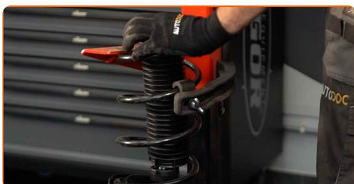
**40** Installer den øvre demperen og monteringslager.
