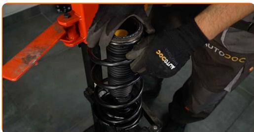
**39** Installer støvbeskytteren og støtstopperen på støtdemperen.
