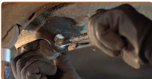
**17** Fjern støtdemperen. Bruk et brekkjern.
