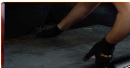
**4** Ta ut fremre nedre kledning fra bagasjerommet.
