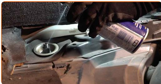
**6** Løsne det øvre festelementet til støtdemperen. Bruk en kombinasjonsnøkkel #18. Bruk Torx T30. Bruk en skrallenøkkel.
