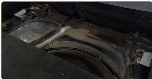
**5** Rengjør festene til støtdemperen. Bruk en stålbørste. Bruk WD-40 spray.
