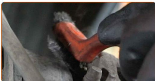
**10** Skru løs festene til bremsekaliperen. Bruk en kombinasjonsnøkkel #15. Bruk en pipenøkkelinnsats #13. Bruk en skrallenøkkel.
