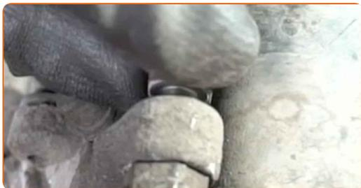
**37** Stram festene til bremsekaliperen. Bruk en kombinasjonsnøkkel #15. Bruk en pipenøkkelinnsats #13. Bruk en momentnøkkel. Stram den til 35 Nm dreiemoment.
