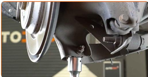
**7** Rengjør festene til støtdempernes øvre montering. Bruk en stålbørste. Bruk WD-40 spray.
