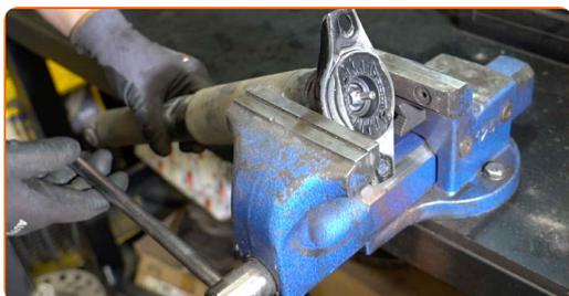
**16** Rengjør festene til støtdemperstangen. Bruk en stålbørste. Bruk WD-40 spray.
