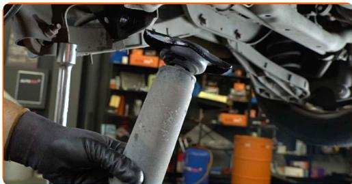
**14** Rengjør monteringsfestet til støtdemperen. Bruk en stålbørste.
