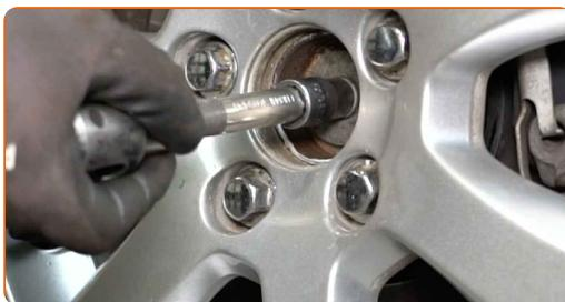
**5** Løs hjulboltene. Bruk en kraftpipe for hjulmutter #19. Bruk et svingjern.
