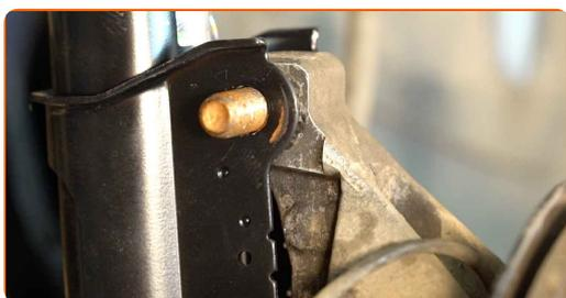
42 Stram nedre fester som kobler fjærbein til styrespindel. Bruk en kombinasjonsnøkkel #18. Bruk en pipenøkkelinnsats #21. Bruk en momentnøkkel. Stram den til 105 Nm dreiemoment.+75°
