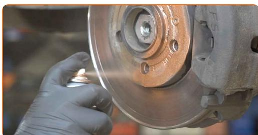
**48** Rengjør overflaten av bremseskiven. Bruk bremsrens.
