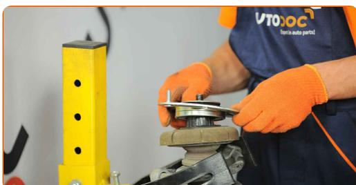
**28** Stram fjærbeinets stempelstangmutter. Bruk en kombinasjonsnøkkel #21. Bruk Torx T50. Bruk en momentnøkkel. Stram den til 70 Nm dreiemoment.
