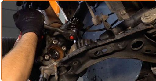
**26** Koble styrespindelen fra fjærbeinet. Bruk en flat metal meisel. Bruk en hammer.
