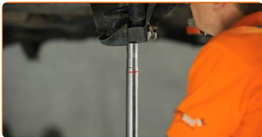
**20** Stram det nedre feste på støtdemperen. Bruk en kombinasjonsnøkkel #16. Bruk en pipenøkkelinnsats #16. Bruk en momentnøkkel. Stram den til 40 Nm dreiemoment.+90°
