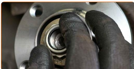
**31** Stram navfestet. Bruk 12-kant-pipe nummer 30. Bruk en momentnøkkel. Stram den til 175 Nm dreiemoment.
