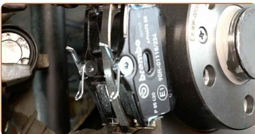
**44** Monter bremsekaliperen.
