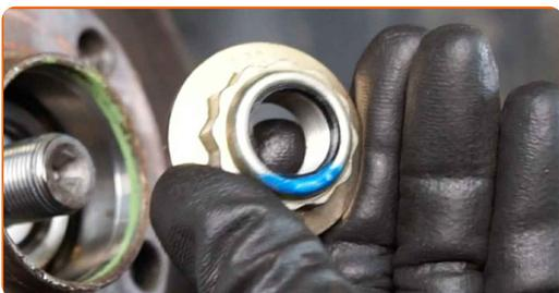
**25** Fjern navet og lageret sammen, siden de er laget som en enhet. Bruk 3-Arm Gear Puller (avtrekker med tre klør for tannhjul).
