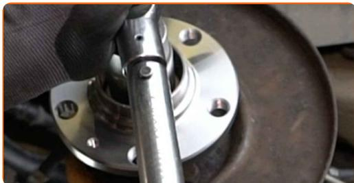
**32** Fest dekselet til navlageret. Bruk en gummihammer.
