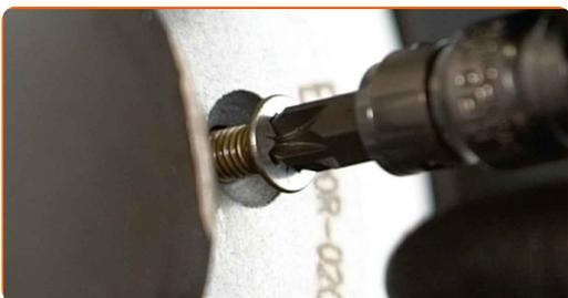
**37** Stram festene til bremseskiven. Bruk en Philips-skrutrekker. Bruk en momentnøkkel. Stram den til 4 Nm dreiemoment.
