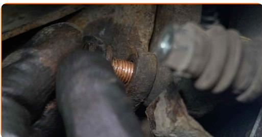
**41** Stram festene til braketten til bremsekaliperen. Bruk HEX nr. H8. Bruk en momentnøkkel. Stram den til 65 Nm dreiemoment.
