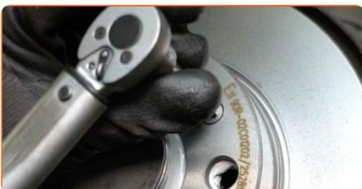
**38** Fjern smuss og støv fra braketten til bremsecaliperet. Bruk en stålbørste. Bruk bremserens.
