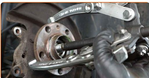
**26** Fjern den indre lagerringen fra akseltappen. Bruk 3-Arm Gear Puller (avtrekker med tre klør for tannhjul).
