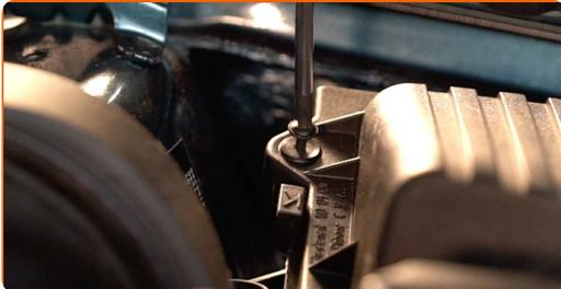
**4** Løsne slangeklemmen på luftinntaket. Bruk vannpumpetenger.
