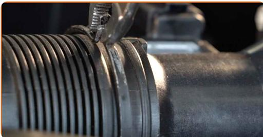
5 Koble fra kontakten til luftmengdemåleren.
