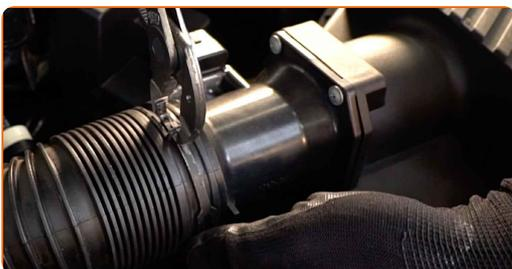
16 Plugg i kontakten til luftmengdemåleren.
