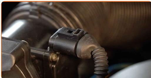
17 Skru festeskruene på luftfilterdekslet. Bruk en Philips-skrutrekker.
