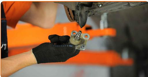
**17** Rengjør kuleleddets monteringsflate. Bruk en stålbørste. Bruk WD-40 spray.
