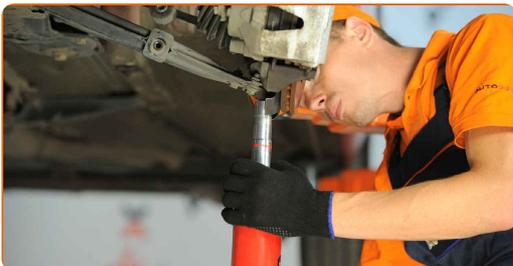
**37** Fest fjærbeinet på styrespindelen. Bruk en hammer.
