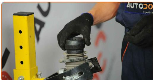
**27** Stram fjærbeinets stempelstangmutter. Bruk en pipenøkkelinnsats #20. Bruk en momentnøkkel. Stram den til 60 Nm dreiemoment.
