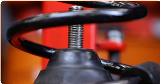
30 Installer den øvre demperen og monteringslager.
