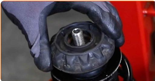
31 Stram fjærbeinets stempelstangmutter. Bruk HEX nr. H7. Bruk en 21 mm pipe for fjærbeinmutter. Bruk en momentnøkkel. Stram den til 60 Nm dreiemoment.
