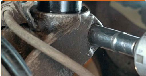
**56** Rengjør rillene på CV-leddet til drivakselen. Bruk en stålbørste. Bruk WD-40 spray.
