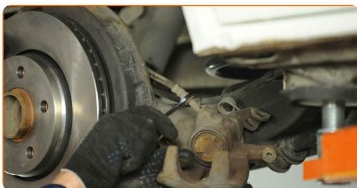
**16** Installer og fikser bremseslangen inn i en ny kaliper.
