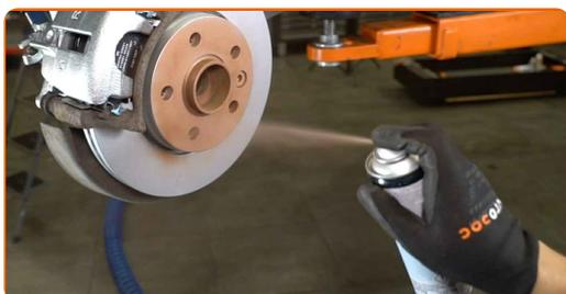
**32** Rengjør overflaten av bremsekiven. Bruk bremserens.
