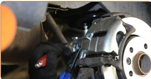
**24** Fjern smuss fra bolten til bremseslangen. Bruk bremserens.
