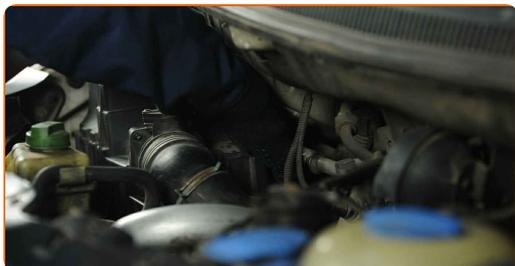
**15** Press klipsene til luftfilterdekselet på plass.
