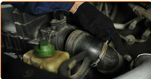
6 Løs klipsene til luftfilterdekselet.
