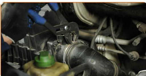
5 Koble røret til luftinntaket fra luftfilterhuset.
