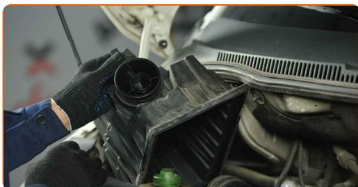
**14** Koble røret til luftinntaket til luftfilterhuset.
