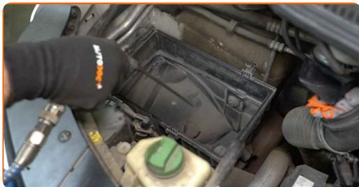
Utskifting: luftfilter – VW California T6 Minibuss (SGC, SGG, SHC). Tips fra AUTODOCs eksperter:
