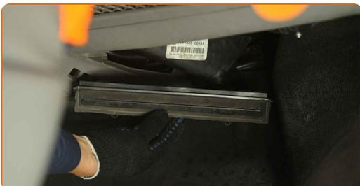
**8** Skru fast festene på dekselet til kupéfilteret. Bruk en pipenøkkelinnsats #7. Bruk en skrallenøkkel.
