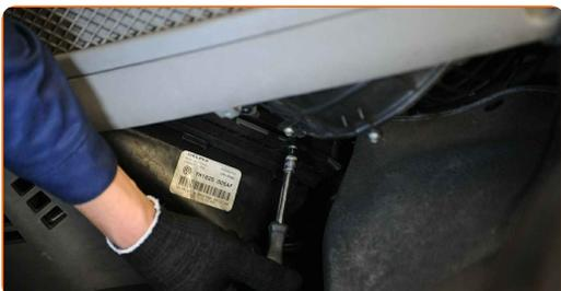
**9** Installer og sikre beskyttelsesdekselet under hanskerommet.
