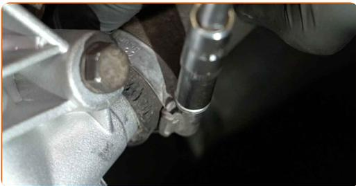
**29** Monter vannpumpeskiven.
