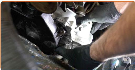
**26** Stram festene til vannpumpen. Bruk en kombinasjonsnøkkel #13. Bruk en pipenøkkelinnsats #13. Bruk en momentnøkkel. Stram den til 14 Nm dreiemoment.
