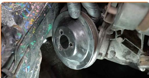
**18** Skru løs festene til vannpumpehuset. Bruk en pipenøkkelinnsats #10. Bruk en skrallenøkkel.
