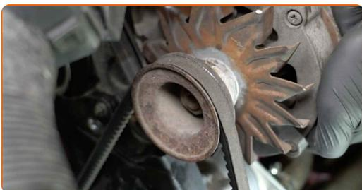
**32** Stram festene til dynamoen. Bruk en pipenøkkelinnsats #13. Bruk en momentnøkkel. Stram den til 10 Nm dreiemoment.
