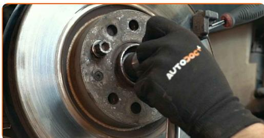
**17** Rengjør festene på braketten til bremsecaliperen. Bruk en stålbørste. Bruk WD-40 spray.
