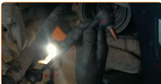
**35** Rengjør festene til hjulnavlageret. Bruk en stålbørste. Bruk WD-40 spray.
