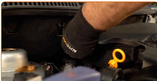
4 Fjern motordekselet. Luftfilterhus integreres i motordeksel.
