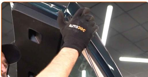
**13** Klem på sikringsringen som kobler gassfjæren til karosseriet.
