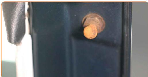
**10** Behandle festene til gassfjæren til bakluken med et egnet middel. Bruk universalfett. Bruk en flat skrutrekker.
