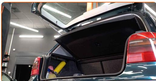
**2** Støtt opp bagasjeluken. Bruk en hydraulisk jekk.
