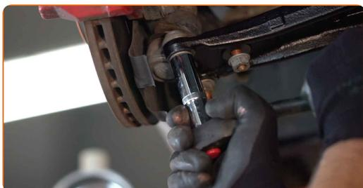
**18** Skru fast de bakre festene som tilkobler bærearman til under rammen. Bruk en pipenøkkelinnsats #15. Bruk en pipenøkkelinnsats #18. Bruk en skrallenøkkel.
