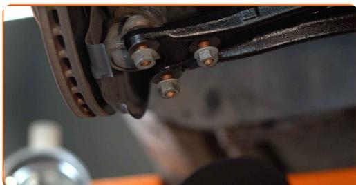
**17** Skru fast festene til kuleleddet. Bruk en pipenøkkelinnsats #15. Bruk en skrallenøkkel.
