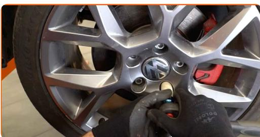
29 Senk bilen og stram hjulboltene, arbeid på kryss. Bruk en momentnøkkel. Stram den til 120 Nm dreiemoment.
