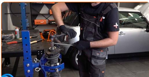
34 Fjern støtdemperfestet, støvbeskytteren og støtstopperen.
