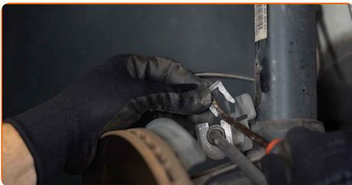
16 Rengjør festene som binder stabilisatorlinken til støtdemperen, og de som binder støtdemper til styrespindel. Bruk en stålbørste. Bruk WD-40 spray.
