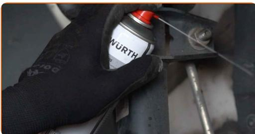
17 Skru løs mutteren og fjern stabilisatorstangen fra fjærbeinet. Bruk en kombinasjonsnøkkel #16. Bruk XZN #6. Bruk en skrallenøkkel.
