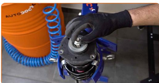
40 Stram fjærbeinets stempelstangmutter. Bruk en pipenøkkelinnsats #21. Bruk HEX nr. H6. Bruk en momentnøkkel. Stram den til 60 Nm dreiemoment.
