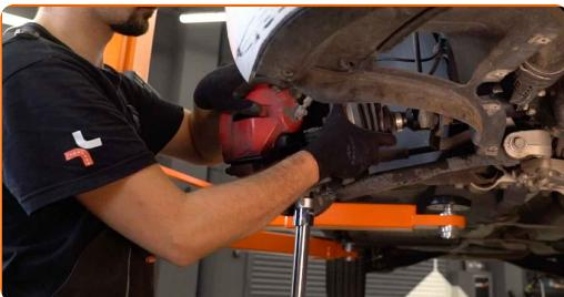
**25** Frigjør nedre feste som kobler fjærbein til styrespindel. Bruk en spesiell pipenøkkel til å fjerne støtdemperen. Bruk en skrallenøkkel.
