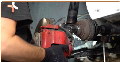
**27** Løft opp styrespindelen. Bruk en hydraulisk jekk.
