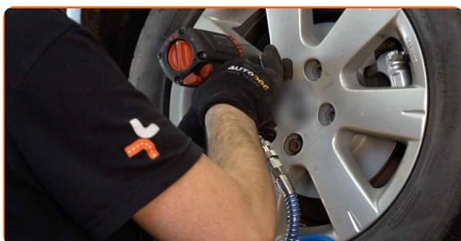
**41** Senk bilen og stram hjulboltene, arbeid på kryss. Bruk en momentnøkkel. Stram den til 120 Nm dreiemoment.
