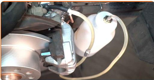
**31** Løsne lufteskruen til bremsen. Bruk en kombinasjonsnøkkel #11.
