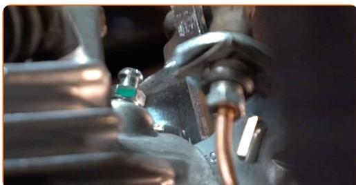
**30** Koble bremseluffer til lufteskruen.
