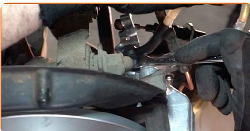
**32** Luft bremsekalipersystemet. Uten å starte motoren, trå på bremsepedalen flere ganger til du føler betydelig motstand.
