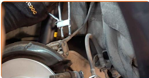
**27** Installer kabelen til parkeringsbremsen inn i braketten til bremsekaliperen. Bruk vannpumpetenger.
