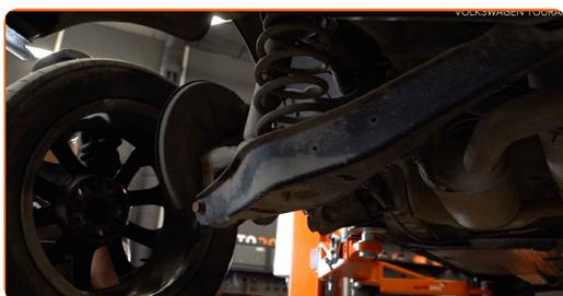
6 Støtt armen. Bruk en hydraulisk jekk.
