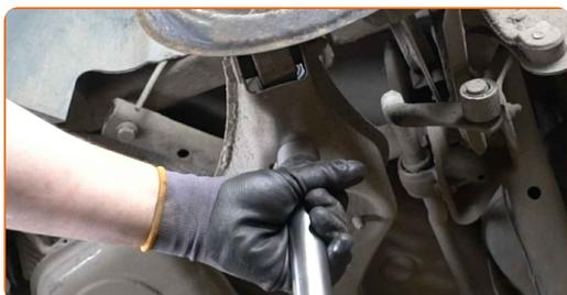
**21** Skru av hjulnavets akselmutter. Bruk XZN #18. Bruk et svingjern.
