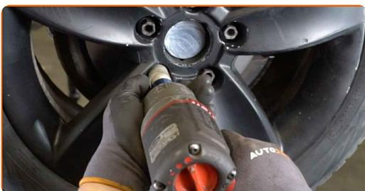
**49** Senk bilen og stram hjulboltene, arbeid på kryss. Bruk en kraftpipe for hjulmutter #17. Bruk en momentnøkkel. Stram den til 120 Nm dreiemoment.
