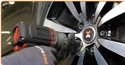
**76** Senk bilen og stram hjulboltene, arbeid på kryss. Bruk en kraftpipe for hjulmutter #17. Bruk en momentnøkkel. Stram den til 120 Nm dreiemoment.
