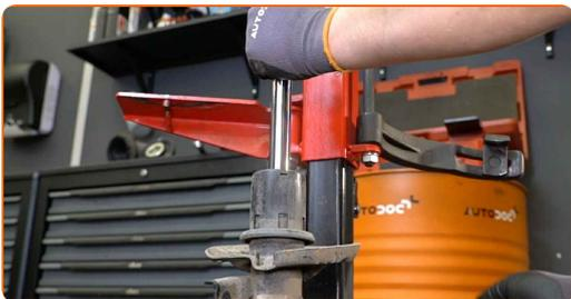
**40** Installer den nye støtdemperen på den hydrauliske kompressoren til spiralfjæren.
