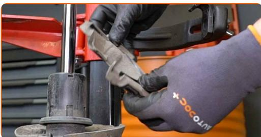
**39** Ta vekk den gamle støtdemperen fra den hydrauliske kompressoren.
