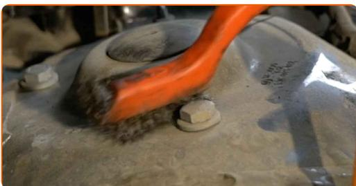
**7** Løsne det øvre festet til fjærbeinet. Bruk en pipenøkkelinnsats #13. Bruk en skrallenøkkel.
