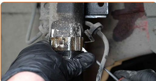
**18** Koble fra bremseslangen. Bruk et brekkjern.
