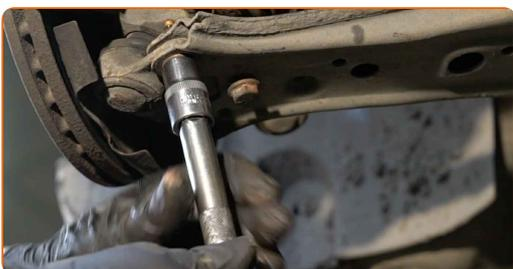
**55** Stram kuleleddfestet. Bruk en pipenøkkelinnsats #13. Bruk en momentnøkkel. Stram den til 20 Nm dreiemoment. +90°
