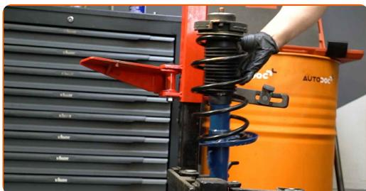
**44** Behandle monteringsstedet til fjærbeinet med et egnet middel. Bruk en stålbørste. Bruk WD-40 spray.
