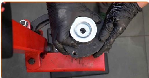
**39** Stram fjærbeinets stempelstangmutter. Bruk HEX nr. H7. Bruk en pipenøkkelinnsats #21. Bruk en momentnøkkel.
