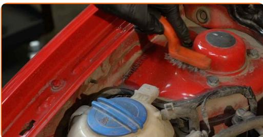
**4** Løsne det øverste festet på fjærbeinets montering. Bruk en pipenøkkelinnsats #13. Bruk en skrallenøkkel.
