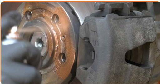
**69** Rengjør overflaten av bremseskiven. Bruk bremsrens.
