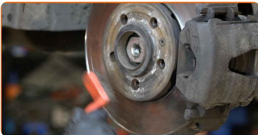
**68** Behandle overflaten hvor bremseskiven kontakter felgen. Bruk kobberfett.
