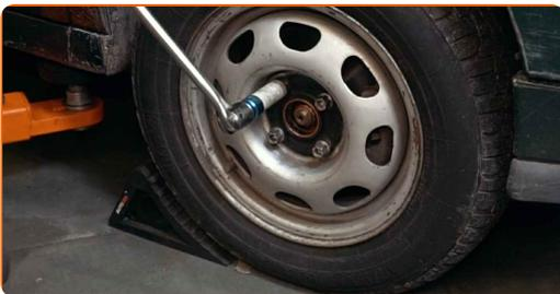
**4** Løsne festet til drivakselen. Bruk en pipenøckelinnsats #30. Bruk et svingjern.
