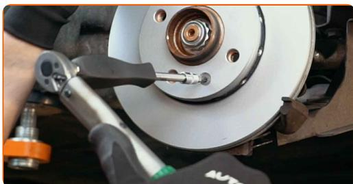
**63** Installer bremsekaliperen og fest den. Bruk HEX nr. H6. Bruk en momentnøkkel. Stram den til 25 Nm dreiemoment.
