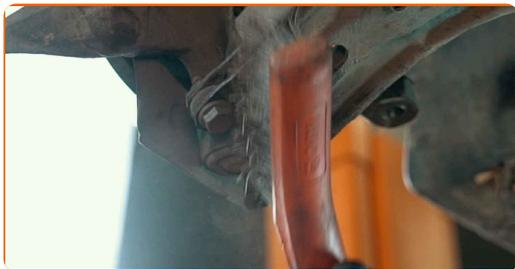
**22** Skru løs festene som binder kuleleddet til kontrollarmen. Bruk en pipenøkkelinnsats #13. Bruk en skrallenøkkel.
