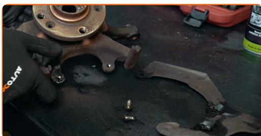
**30** Ta hjulnavet av fra at styrespindelen. Bruk et avtrekkersett for hylser og lager.
