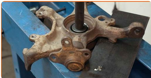
**31** Dra innerringen på lageret ut av hjulnavet. Bruk et avtrekkersett for hylser og lager. Bruk en lageravtrekker.
