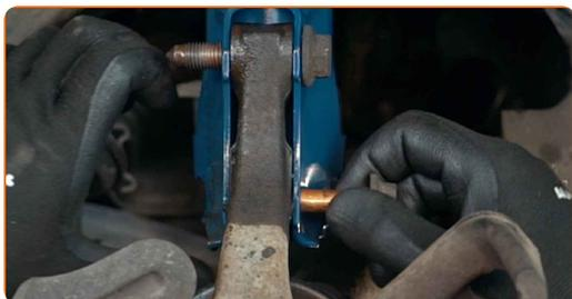
**21** Rengjør festene som kobler kuleleddet til styrearmen i hjulopphenget. Bruk en stålbørste. Bruk WD-40 spray.
