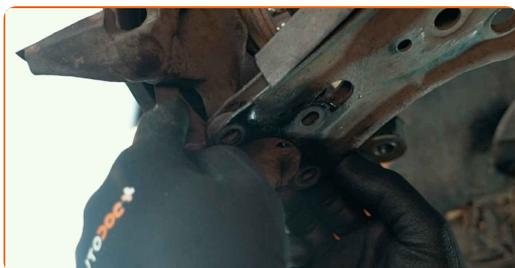
**24** Fjern drivakselen fra styrespindelen. Bruk en spikerdor. Bruk en hammer.
