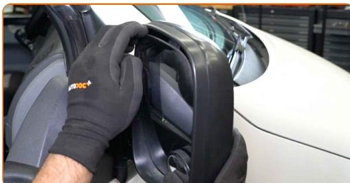
3 Løs speilglasset forsiktig fra festet. Bruk et verktøy for trimming, plast. Bruk en flat skrutrekker.
