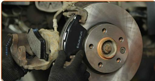
Utskifting: bremseklosser – VW Multivan VI (SGF, SGM, SGN). Tips fra AUTODOCs eksperter:
