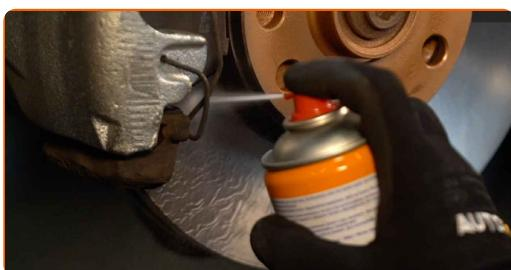
**Utskifting: bremsekaliper – VW PASSAT (3B3). AUTODOCs eksperter
