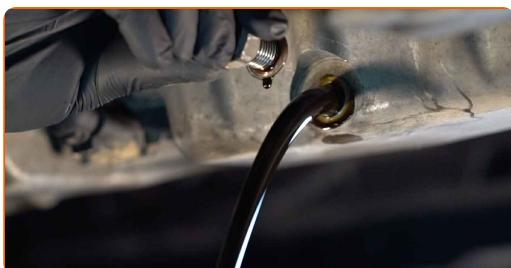
Utskifting: motorolje og oljefilter – VW Passat B2 Variant (33B). Tips fra AUTODOC:
