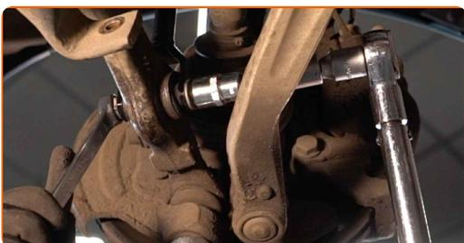
**54** Stram de øvre kontrollarmfestene (2 stykker). Bruk en kombinasjonsnøkkel #16. Bruk en pipenøkkelinnsats #16. Bruk en momentnøkkel. Stram den til 40 Nm dreiemoment.
