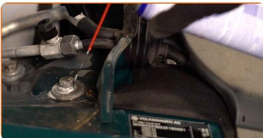
**6** Løsne det øverste festet på fjærbeinets montering. Bruk en pipenøkkelinnsats #16. Bruk en skrallenøkkel.
