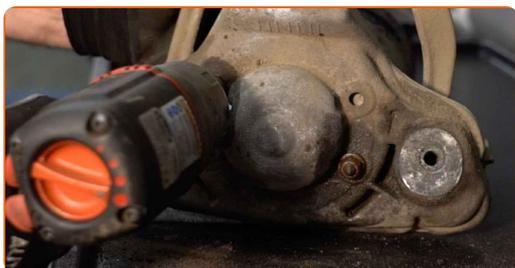
**28** Fjern det øvre festet til støtdemperen, som er montert med bæreamene.
