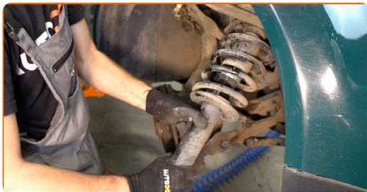
**26** Rengjør festene på fjærbeinets øvre sete. Bruk en stålbørste. Bruk WD-40 spray.
