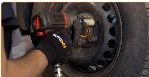
**65** Senk bilen og stram hjulboltene, arbeid på kryss. Bruk en momentnøkkel. Stram den til 120 Nm dreiemoment.
