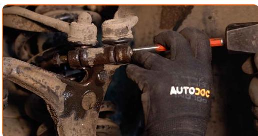
**15** Fjern den øvre bæreamen fra rattspindelen (2 stykker). Bruk et brekkjern.
