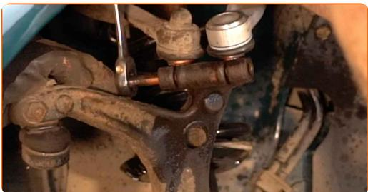
**51** Skru inn festene (2 deler) til den øvre bæreamen. Bruk en kombinasjonsnøkkel #16. Bruk en pipenøkkelinnsats #16.
