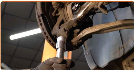
**53** Stram det nedre festet på støtdemperen. Bruk en kombinasjonsnøkkel #18. Bruk en pipenøkkelinnsats #18. Bruk en momentnøkkel. Stram den til 90 Nm dreiemoment.
