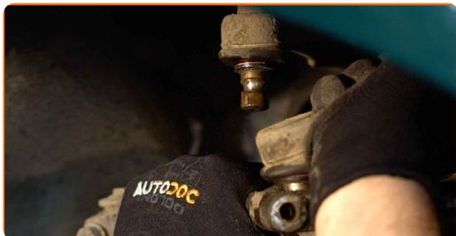
**16** Rengjør festene til stabilisatorleddet. Bruk en stålbørste. Bruk WD-40 spray.
