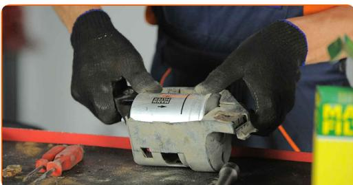
Utskifting: drivstoffilter – VW Passat B5 Stasjonsvogn (3B5). AUTODOC anbefaler:
