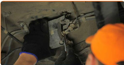
Utskifting: drivstoffilter – VW Passat B5 Stasjonsvogn (3B5). Tips:
